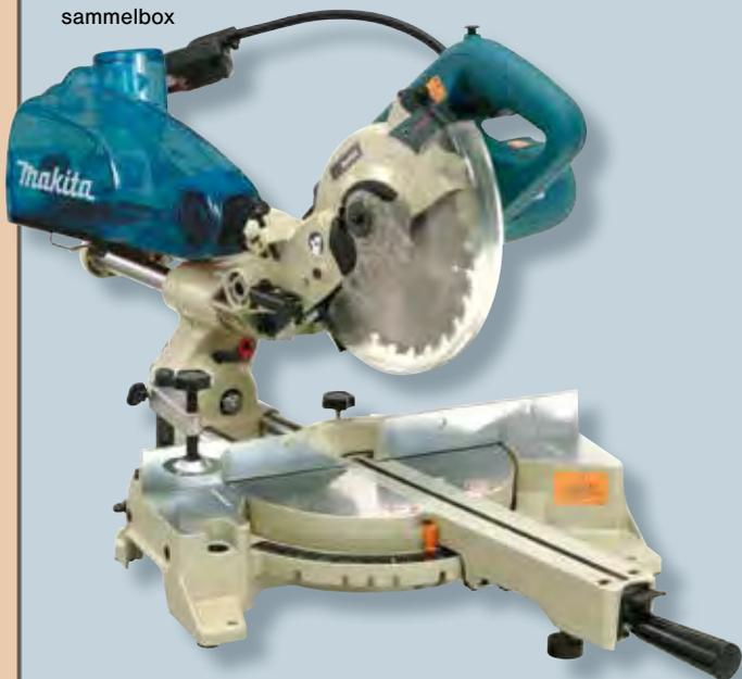
**INFO** Durch Hinterlegen einer Holzleiste von 20 mm ist eine Schnittleistung von 60 x 265 mm zu erreichen!
