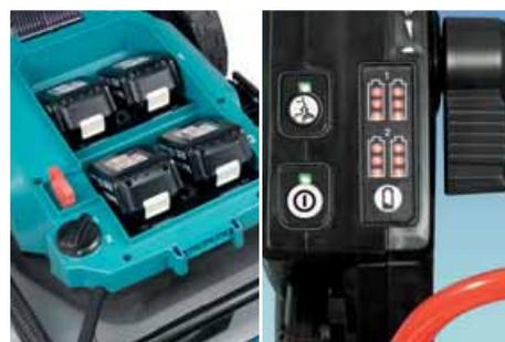
Akku-Box für vier Akkus, die mittels Schalter paarweise ausgewählt werden können
