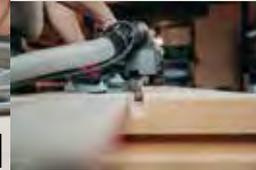
Mit dem im Sonderzubehör erhältlichen Verstellnuter können Nuten zum Beispiel für Versorgungsleitungen effektiv und schnell eingefräst werden.
