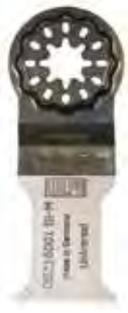
Werkstoff Säge: Bimetall Die geschränkte Hobelverzahnung sorgt für hervorragende Schnittqualität und eignet sich für Schnitte in allen Holzarten mit Metallrückständen bis 4,0mm, weichen Mauerwerksrückständen, Kunststoffen und Gipskarton. Das schmale und taillierte Blatt gewährleistet schnelle Spanabfuhr und guten Sägefortschritt. Erhöhte Standzeit!
