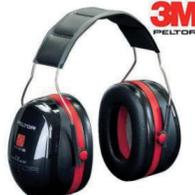
Optime™ III ist ein Kapselgehörschützer mit extrem hoher Dämmleistung, entwickelt für besonders starke Lärmbelastungen. Dieser Gehörschützer basiert auf einer Doppelschalentechnologie, die die Resonanz im Inneren der Kapsel minimiert. Das Ergebnis: maximale Dämmung hoher Frequenzen, wobei Gespräche und Warnsignale immer noch gut zu verstehen sind.
