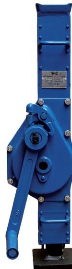
Die Stahlwinden entsprechen der DIN 7355. Diese Norm enthält alle technischen Vorschriften, die zur Gewährleistung der notwendigen Sicherheit bei bestimmungsgemäßer Verwendung eingehalten werden müssen. Die Sicherheitskurbel besitzt eine Reibungslastbremse, die so eingerichtet ist, daß sie beim Loslassen der Kurbel bremsend wirkt und die Last in jeder gewünschten Höhe festhält. Ein Zurückschlagen der Kurbel ist ausgeschlossen. Der Kurbelgriff ist umklappbar.
