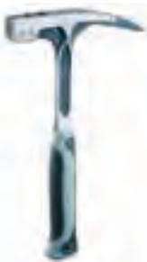
**Latthammer Vollstahl, 600 gr.** DIN 7239/VPA GS geprüft aus Qualitätsstahl in einem Stück geschmiedet, Kopf blank mit Schutzlack, ausgewogene Gewichtsverteilung, durchgehender Schaft bis zum Griffende, mit Nagelrille und Magnet, gerauhte Bahn mit blau/schwarzem ergonomischen 2-Komponenten-Griff (PAK-frei)
