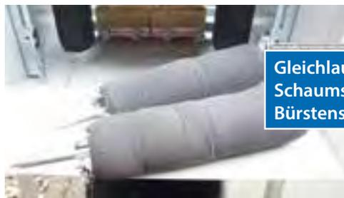
Gleichlaufender „Farbauftrag“ durch Schaumstoffwalzen. Bürstenstriche werden vermieden.
