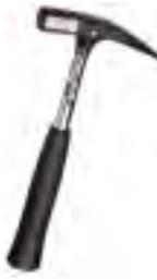
Kopf schwarz pulverlackiert, korrosionsgeschützt. Aus legiertem PICARD-Spezialstahl, sorgfältig gehärtet und angelassen. Mit magnetischem Nagelhalter. Mit Kopfsicherung C45 Stahlrohrstiel **1 Komponenten-Griff, traditionell** GS-geprüfte Sicherheit VPA Certified DIN 7239
