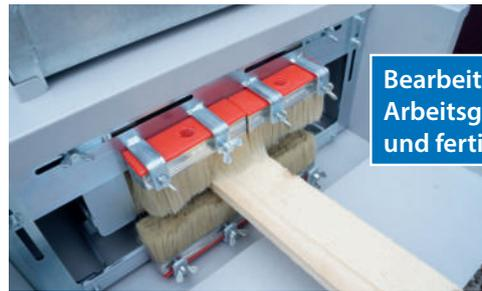
Bearbeitung von 4 Seiten in einem Arbeitsgang: Bretter durchschieben und fertig!!
