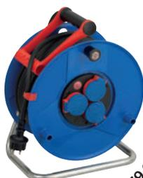
Betriebsmittel der Kategorie 2 (K2): Einsatz für den rauen Betrieb mit hohen mechanischen, physikalischen und chemischen Einwirkungen. RN-Kabel ist zugelassen für erschwerte Baubedingungen nach VDE 0100 Teil 704. 3 Schutzkontakt-Steckdosen mit Überhitzungsschutz und selbstschließenden Deckeln. **40 m robustes, ölbeständiges Kabel H07RN-G 3G1,5.**
